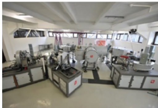
Acceleratorul Tandem 1MV folosit pentru studii de datare cu ^{14}\text{C}
